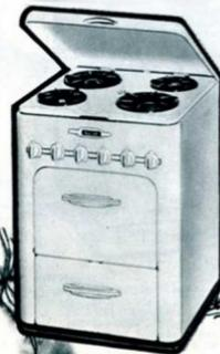
**B. 11 - SAUTER** « 123-2 G G » - Dim. ext. (l x p x h) : 600 x 600 x 800. Dim. four (l x p x h) : 360 x 340 x 240. Interallumage des brûleurs du dessus par veilleuse centrale. Voyant lumineux signalant l'ouverture des manettes. Grilloir à plafond rayonnant - Coffre à accessoires.
